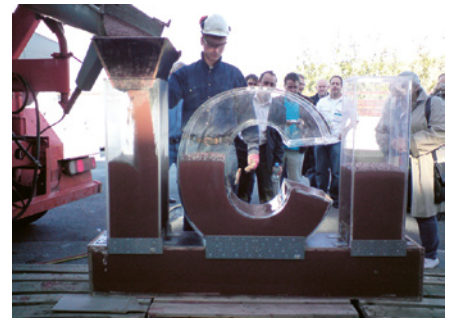
Einfüllen von selbstverdichtendem Beton in eine Schalung. Foto: ABW (Innovation Center Iceland)
